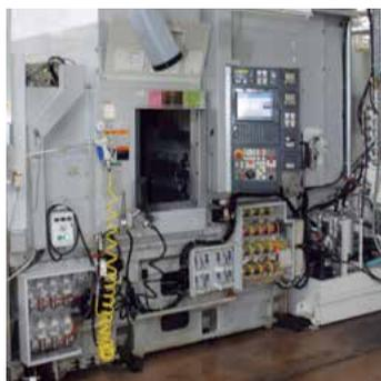
首先，通过采用精密隔膜式卡盘，实现了高精度的夹持。下一个课题是 Z 轴的就位精度问题。
