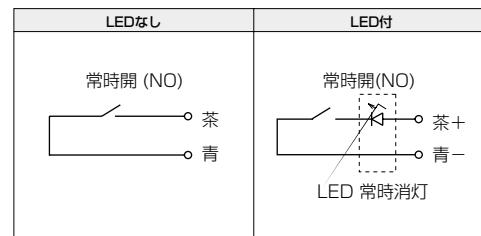
LED付の場合、LEDに10mA以上の電流が流れないよう、電流制限が必要です。
